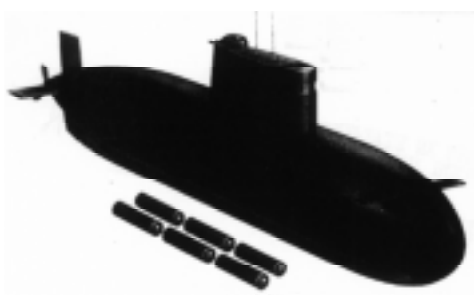
Рис. 7. Сверхмалая подводная лодка «Пиранья» производства британской фирмы «GEC марин» с образцами водонепроницаемых канистр
