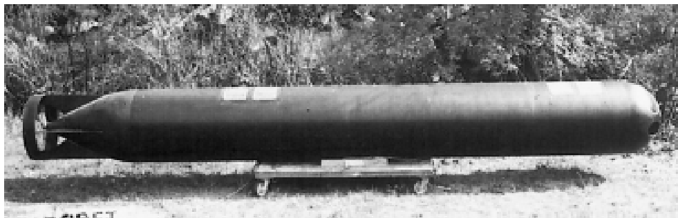
Рис. 3. Подводное средство доставки типа Mk9 французской фирмы «Хавас»
